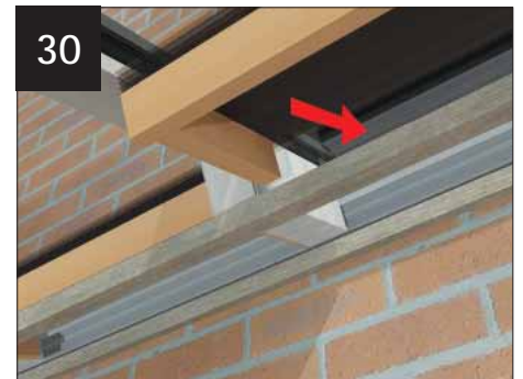
30 Glisser les caches restants en position. S'assurer que le linteau fixé sur le cache soit décalé de 6 mm, et visser pour fixer.
