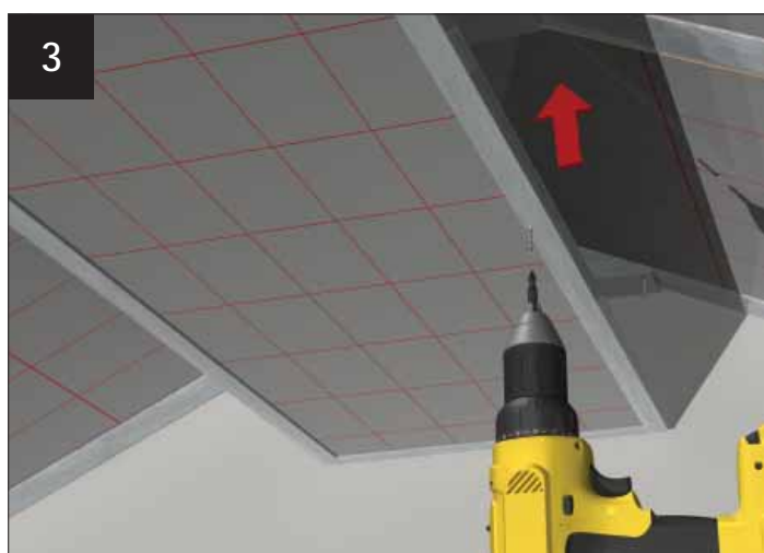
Un cadre pour le panneau central a été préfabriqué en usine.. Positionner ce cadre autour du panneau central. Fixer à l'aide de vis pour placo.
