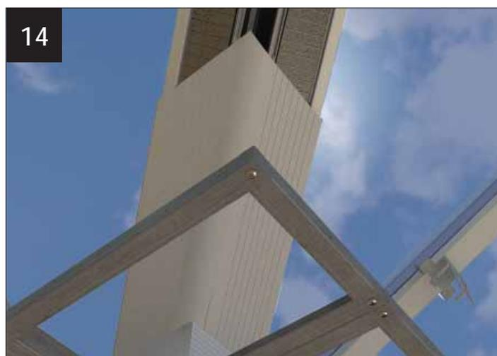
esurer et monter les habillages intérieurs NVU-V de la noue entre la sablière et la marque "C". Ajuster.
