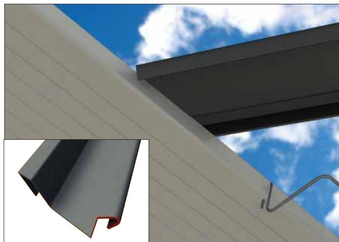
Dans les noues, le support de cache d'armature repose sur le profilé récupérateur des eaux. L'extrémité de ce support doit être découpée comme montré ci-dessus, ce qui permet à ce support de reposer à plat (sur le profilé de récupération).
