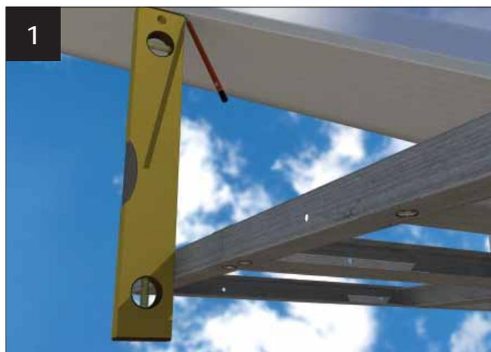
1 Vérifier l'aplomb (vertical) sur le côté de l'armature horizontale Marquer "A" les arêtes extérieures des habillages de la noue (des deux côtés).
