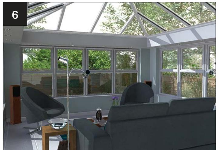
6 La mise en oeuvre de la structure métallique qui reçoit des plaques de plâtre permet de créer un plafond périphérique idéal pour une ambiance "maison" et pour l'aménagement d'un éclairage encastré.
